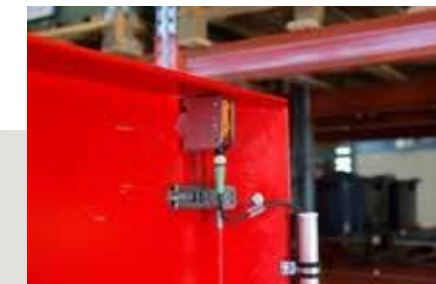
Snímač přeplnění pro jednotky M a L namontovaný na bezpečnostním nástěnném nastavci
